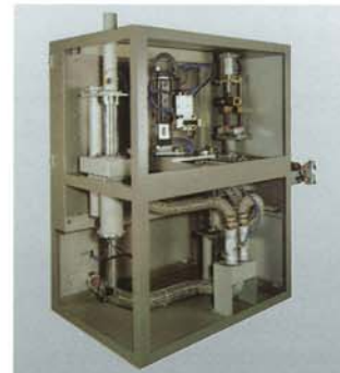
受信ステーション内部： 気送管 気送子マニピュレータ 気送子オープナー
