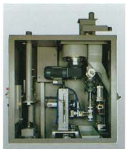
送信ステーション内部： ミキサー 計量機構 気送子マニピュレータ
