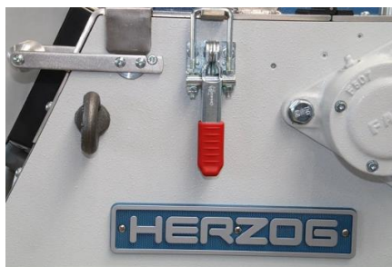
簡単な粉碎室の点検
